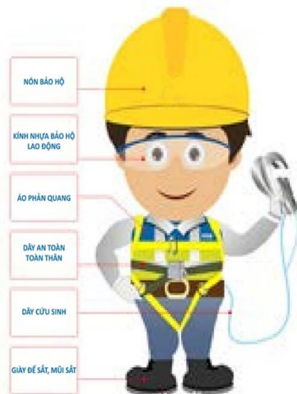
Trang thiết bị bảo hộ lao động tại công trường.
